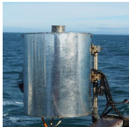
Рис. 1.1. Измеритель спектрального состава выходящего из водной толщи излучения ПРО-1(слева) и датчик надводной облученности ДНО (справа).
