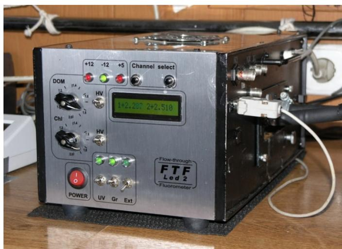
Рис. 1.9. Проточный флуориметр ПФД-2.
