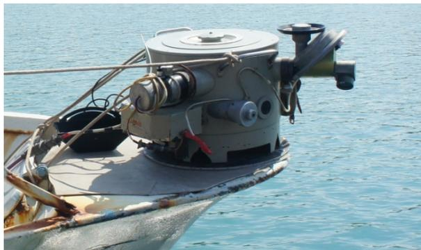
Рис. 1.2. Палубный спектрофотометр.
