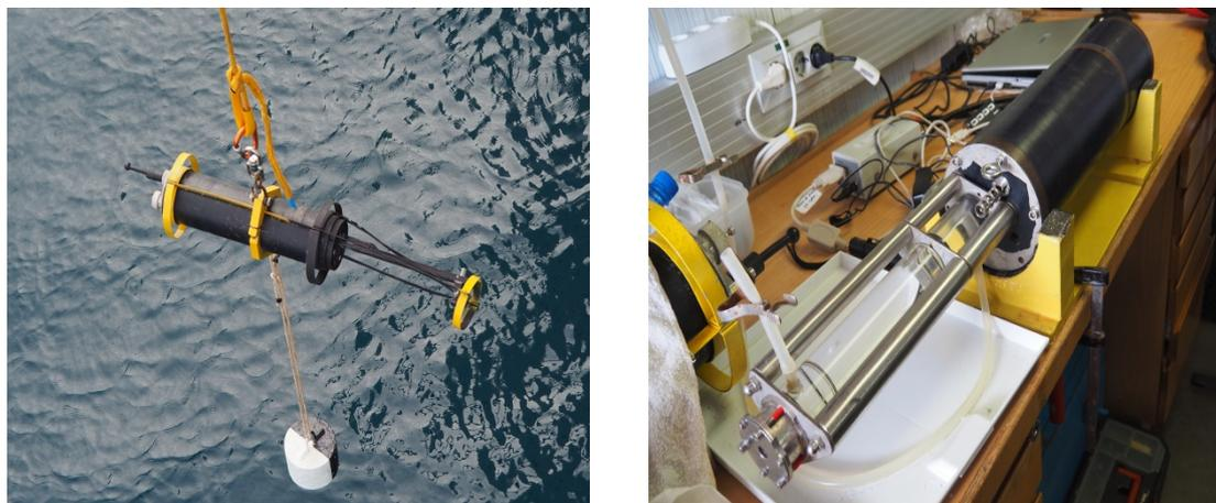
Рис. 1.6. Прозрачномеры: ПУМ перед началом зондирования (слева) и ПУМ-А в режиме лабораторных измерений (справа).
